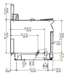
Electrical inlet (power) EQ Equipotential screw
